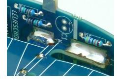
Wenn es in gutem Zustand ist, kann der Mast oben und unten gelötet werden. Lassen Sie den PCB nach dem Löten einer Oberfläche gut abkühlen. Die anderen Teile werden auf die gleiche Weise montiert.
