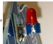
Die zweite Möglichkeit, dieses Problem zu lösen, besteht darin, einen der LED-Anschlüsse im rechten Winkel zu biegen. Dieser Winkelanschluss kann dann direkt am Mast angelötet werden. Einen Draht abschneiden, den anderen Draht biegen, auch diesen Draht zuschneiden. Löten Sie den geraden Draht an das Lötpad. Der gebogene Draht wird direkt am Mast angelötet (Foto rechts).
