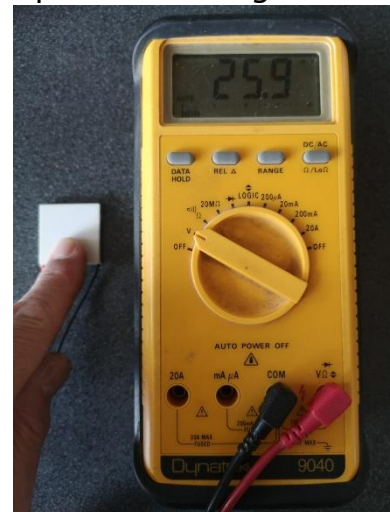
Messung der Spannung des Peltier-Elements. Links: Spannung ca. 0 Volt, Mitte: Spannung negativ, rechts: Spannung positiv.
