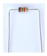
Leiterplatte auseinander. Die platine kann nun gedreht werden, um zu löten, ohne dass der Widerstand aus dem platine fällt. Schneiden Sie die Beine direkt nach dem Löten über die Lötstelle, auch für alle anderen Bauteile mit längeren Schenkeln wie LED und Kondensator. Wenn Sie Zweifel hinsichtlich der korrekten Platzierung haben, sehen Sie sich die Fotos
