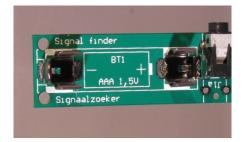
Legen Sie die Batterie (AAA 1,5 V) in der Klemme und Stecker der Kopfhörer. Das Signal-Finder ist jetzt einsatzbereit! Der Druckschalter schalt das gerät an.Lauschen Sie den Klängen eines Handys, TV, oder ein elektrisches Licht waxine .....Viel Spaß!
