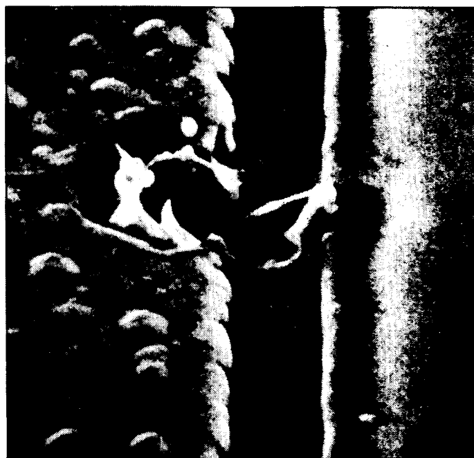
Onderstaande foto toont een beschadigd printspoor door statische lading.
